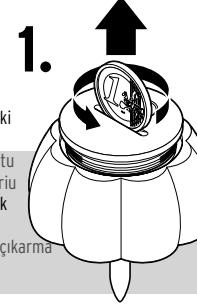
Odkrywanie pokrywki komory baterii
